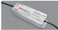
HLG-80H-12 ※ヒューズ付 出力電圧：80W 定格：DC12V 6.7A 重量：840g 寸法：195.6×61.5×36.8mm
